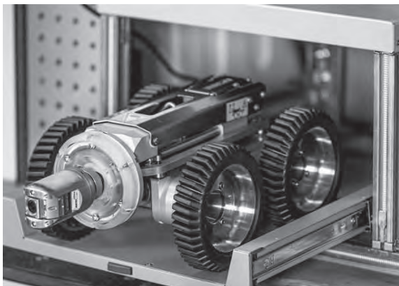
Abbildung TV-Kamera für Zustandserfassung
